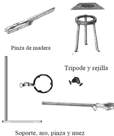
1. **Pinza de madera:** Sujetar tubos de ensayo calientes.
