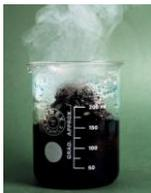
Las reacciones exotérmicas son aquellas reacciones donde se libera calor, esto significa que la energía de las moléculas de los productos es menor que la energía de las moléculas de los reaccionantes.
