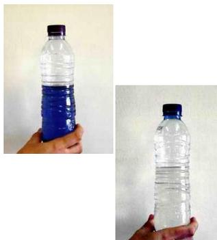
Esta transformación va asociada, a cambios de color que se pueden detectar fácilmente. En este experimento se trabaja con una reacción y un indicador ácido-base que se decolora, de azul a transparente, pero que vuelve al color inicial bajo determinadas condiciones.
