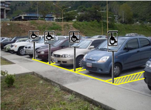
El cajón de estacionamiento deberá ser de 3,80 por 5,0 mts, con una franja de circulación señalizada, con pavimentos antiderrapante, señales de poste, señalización en el piso, topes para vehículos, cintas táctiles para el invidente.
