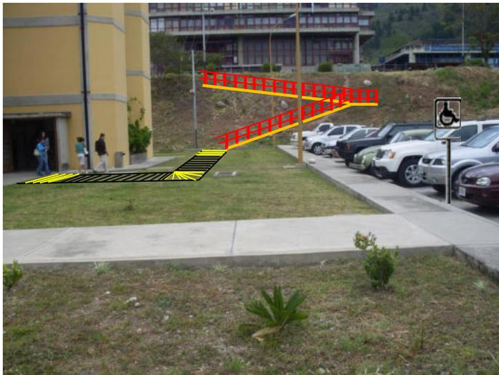
**Nota:** Las áreas de aproximación inicial y final de la rampa deben estar libres de obstáculos, con cambio de textura de piso, el piso de la rampa debe tener un acabado antiderrapante, con pasamanos a 0,75 y 0.90 mts de altura y un borde de protección en ambos lados de 5 por 5 cms.
