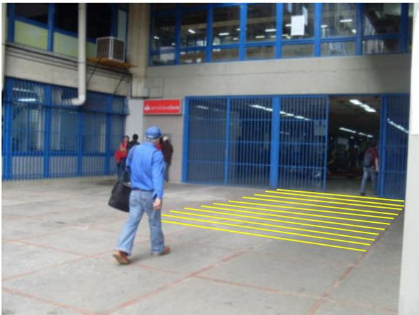
**Nota:** Las áreas de aproximación a los accesos de las edificaciones deben estar libres de obstáculos, con cambio de textura de piso, para que el discapacitado visual, pueda identificar rápidamente las entradas y salidas.
